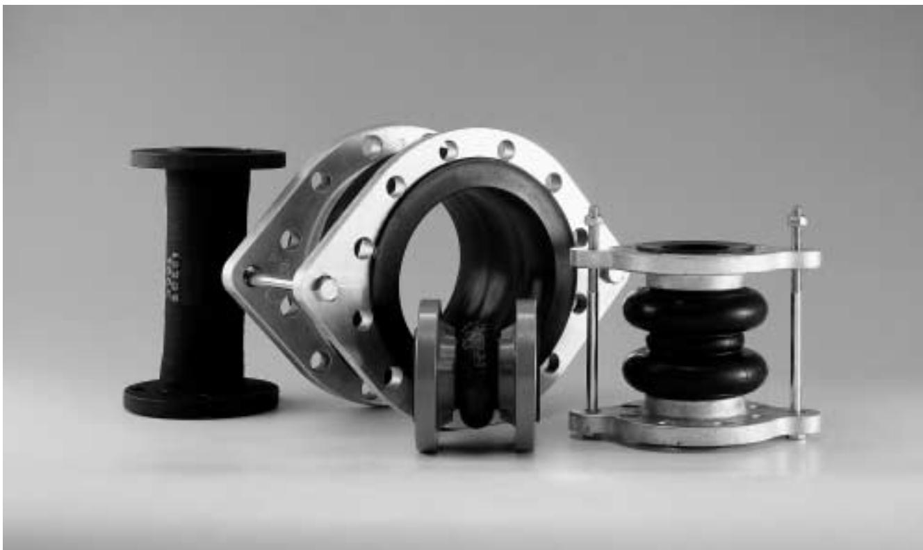
近年、工場や建築設備および電力・上下水道施設等に使用される配管システムは、著しく複雑、多様化し、又安全性に対する要求もますます大きくなっています。ゴム製フレキシブル継手は、これらの配管系統から発生する振動・騒音の防止、温度変化・圧力変化による配管系の伸縮や変位の吸収、さらには施工時の様々な寸法変動の吸収や地震・地盤沈下による影響の緩和・防止等の用途に使用され、配管設備においてはかかせない部材とされています。内外E-Pジョイントは、1970年に高架水槽用として低圧型Rタイプを発売以来、高圧型Pタイプ、PTFEとの一体化製品であるFタイプ等、顧客ニーズに応える新製品を加え、現在では家庭用飲料水から化学プラント薬液配管まで広範囲な分野・様々な業種の顧客のみなさまにご使用いただいております。
